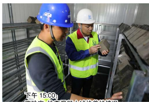
下午 15:00: 实验室，检查混凝土试块养护情况。
